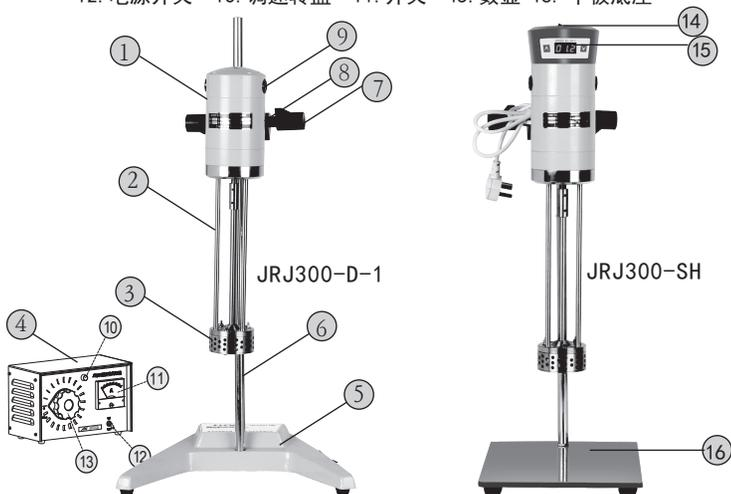
4.1 将本机的机座（5）、（16数显）放在平台上，取两根长的立柱（6）用螺纹连接成一体，再将其固定在机座的安装螺孔内，然后把支撑固定架（7）套入在立柱上方，并转动支撑固定架的手柄予以固定。
